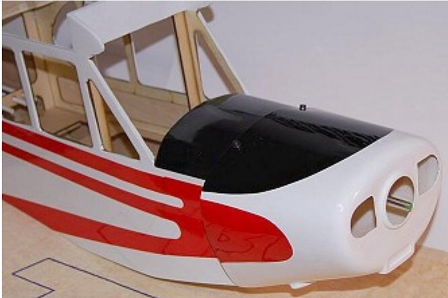
Für meinen vorgesehenen Motor konnte ich den beiliegenden Motorhalter nicht verwenden, aus diesem Grund habe ich einen Motorspant aus Plexiglas angefertigt, der von vier M5-Gewindestangen gehalten wird. Vorteil dieser Konstruktion ist auch die leichte Einstellbarkeit des Motorsturzes sowie Seitenzuges.
