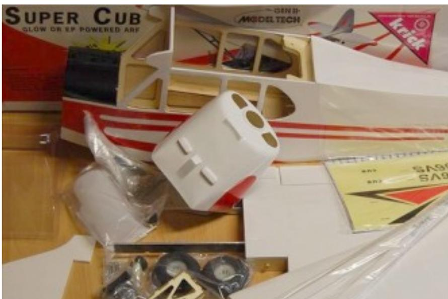
Die Motorhaube ist aus GfK und sauber lackiert, das Fahrwerk besteht aus einem sehr steifen Alubügel und muss noch lackiert werden. Die vorgesehene Ausrüstung übernahm ich größtenteils aus der alten Piper, dazu kamen noch vier Servos DS8077 für die Querruder und Landeklappen. Motor ist ein SHP XL07 mit einer Luftschraube 15x7.
