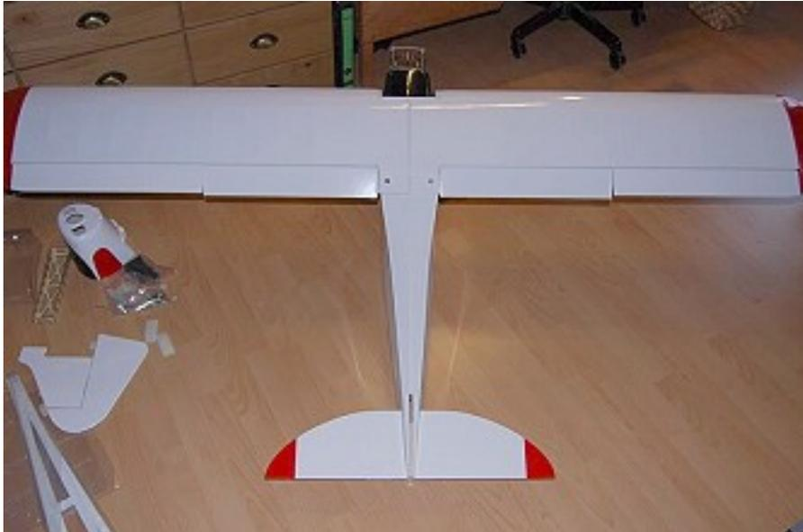
Ä Die Ruder werden mit den bekannten Fließscharnieren befestigt. Die Schlitz für die Scharniere sind schon eingearbeitet. Geklebt habe ich die Scharniere mit dickflüssigem Sekundenkleber, nützlich ist ein vorheriger Trockenlauf wie man am besten die Teile ineinander steckt. Ä
