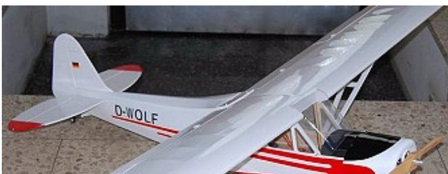
Der Bereich des Schwerpunktes wird in der Anleitung von 70mm bis 95mm hinter der Nasenleiste angegeben. Ich kam ohne weiteres Gewicht auf 90mm, durch Erfahrungen mit der alten Piper habe ich es erst mal so gelassen. Am Tag des Erstfluges war auch die zweite Piper in unserem Verein fertig geworden, so daß erst mal ein paar Bilder gemacht wurden.
