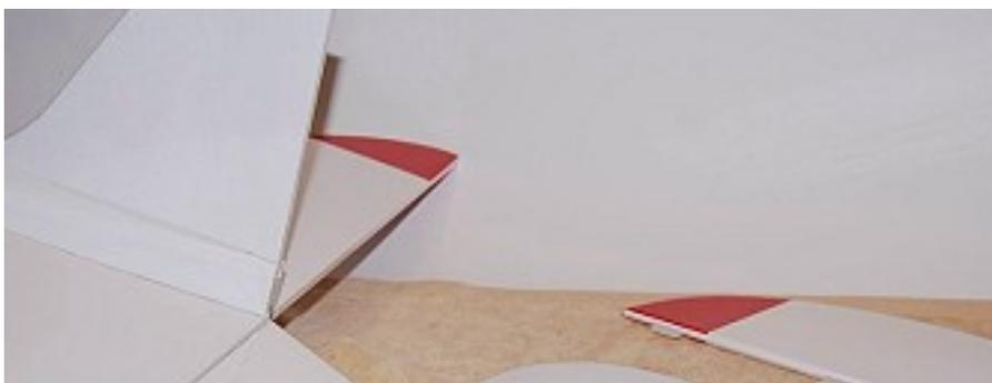
Â Die Anlenkungen sind alle im Baukasten enthalten. Wie sich später bei der Piper eines Vereinskollegen zeigte, sollte man allerdings die Plastikgabelköpfe nicht verwenden, da diese recht schnell brechen. Ich hatte diese allerdings schon beim Bau gegen Metallgabelköpfe ausgetauscht.
